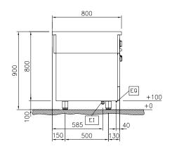
Electrical inlet (power) Equipotential screw
